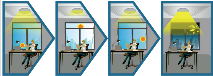
Използване на сензор MS0110 с едно осветително тяло в помещението
